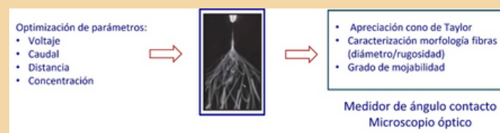
Figura 3. Optimización de los parámetros operacionales (voltaje, caudal, distancia punta-colector) y de solución polimérica (concentración final) para la obtención del cono de Taylor por la técnica de electrospinning.
