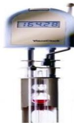
**Fig.1.** Viscosímetro capilar de vidrio ViscoClock
